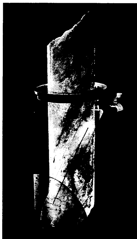
Fig. 4. Stensalt kernestykke med monteret strygning og hældnings udstyr. Azimut ringen er anbragt omkring kernen og aflæses i forhold til orienteringsridsen, der indgraves under kernetagningen. Måling af hældningen foretages med vinkelmåler i relation til kernens side. Boring To-11, kerne nr. 12, 1365,36 - 1365,76 m under den roterende boreplade (rotary table).
